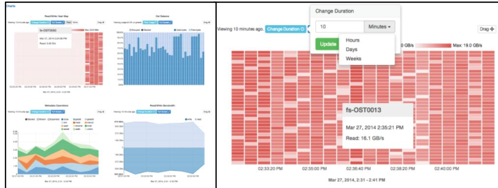
集成显示面板整合各种图表显示性能和资源利用率。系统管理员可以很容易地浏览文件系统，监测作业的资源利用状态以及性能。
